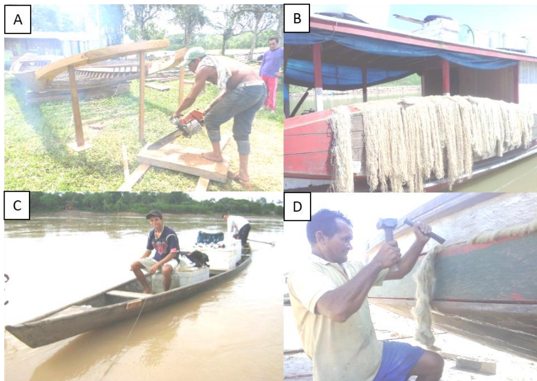
Figura 2. Embarcações pesqueira no Município de Envira rio Tarauacá: (a) construção de barco, (b) Barco mãe, (c) casco com rabeta, (d) manutenção calafeto.
