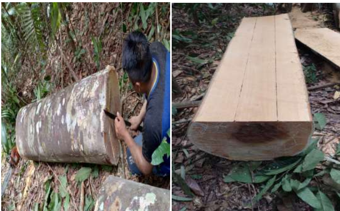
Figura 16-Processo de medição para cortar o arco (Imagem de Alexandre A de Souza, 2024).
