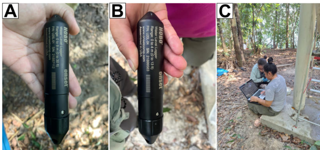
Figura 10 – Monitoramento do nível d'água (NA) nos piezômetros. A – Transdutor de pressão da marca HOBOS. B – Transdutor barométrico da marca HOBOS. C – Medição do nível estático com uma trena adaptada. D – Programação dos transdutores feita previamente utilizando o notebook e o software gratuito HOBOWare.
