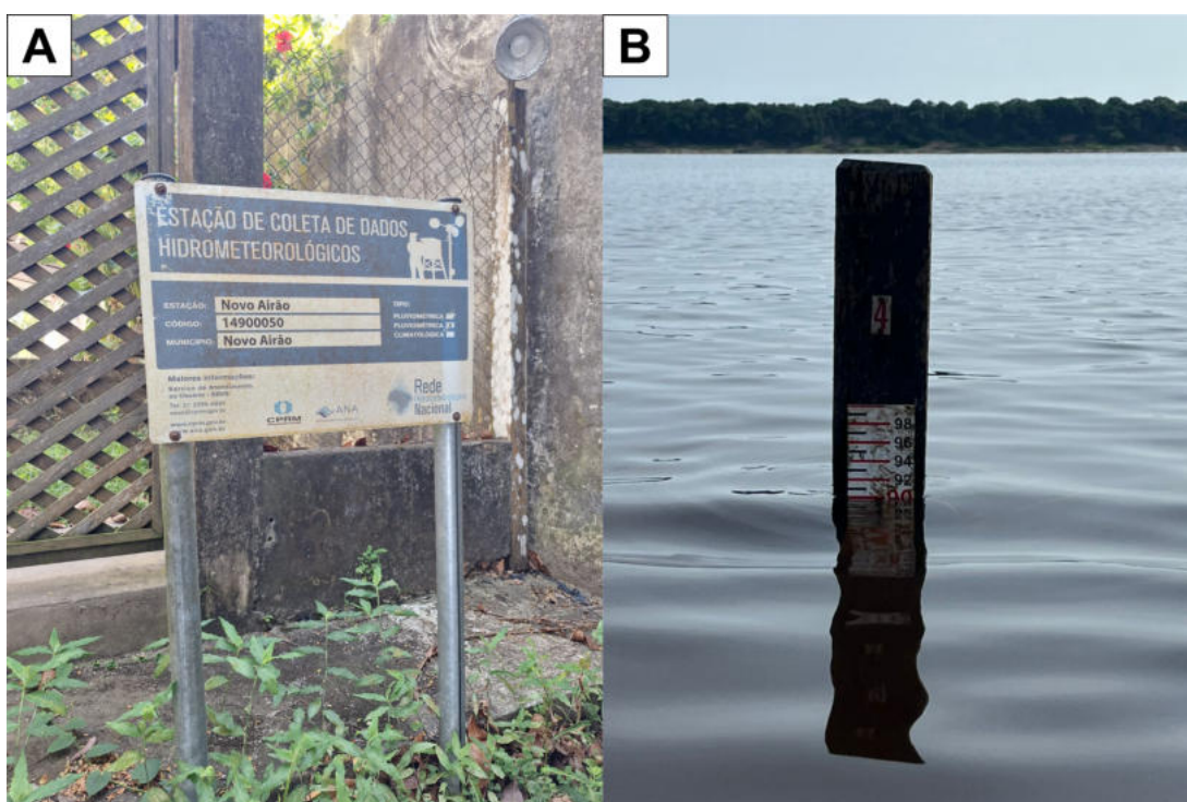
Figura 11 – Local do monitoramento da cota do rio Negro. A – Placa da Estação de coleta de dados hidrometeorológicos do município de Novo Airão, denominada “Novo Airão” e com código de nº 14900050. B - Régua de medição registrando 3.90 m de cota do rio Negro em 17 de outubro de 2024.
