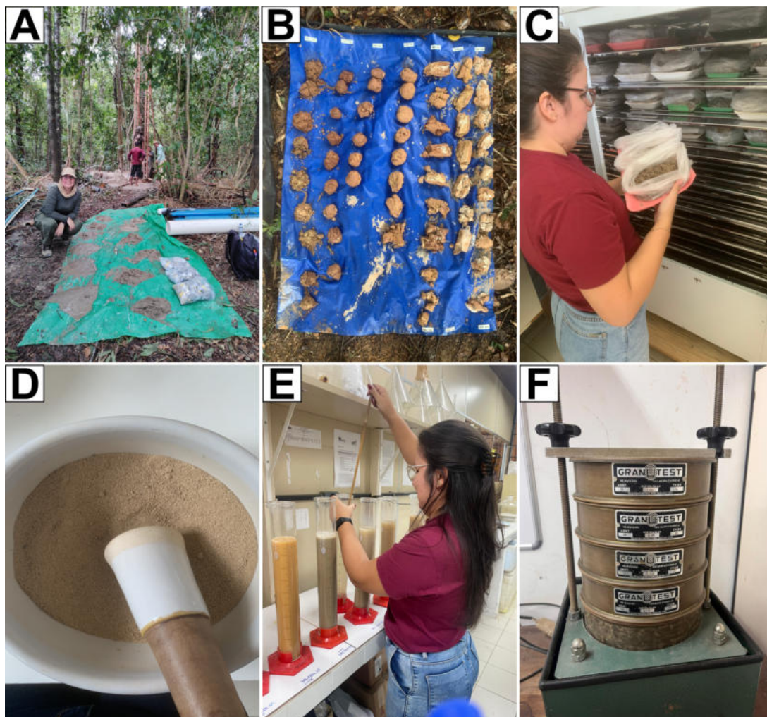
Figura 6 – Procedimentos executados na análise granulométrica. A – Descrição dos sedimentos a cada metro perfurado do NAI-PZ01. B – Amostras provenientes da perfuração a trado do NAI-PZ02. C – Secagem das amostras na estufa. D – Destorroamento das amostras com a utilização do pistilo de cerâmica. E – Aplicação do método da pipetagem apenas com grãos menores que 2 mm. F - Separação dos grãos de fração areia.
