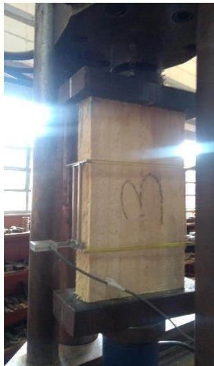
Figura 15: Ensaio de compressão paralela
