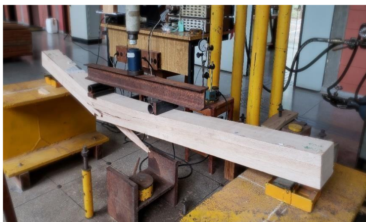
Figura 23: Ruptura do corpo de prova no ensaio de flexão em viga de MLC.
