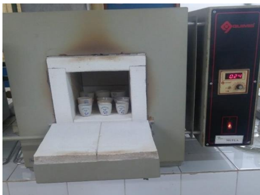
Figura 6: Cadinhos de porcelanas alocados na mufla.
