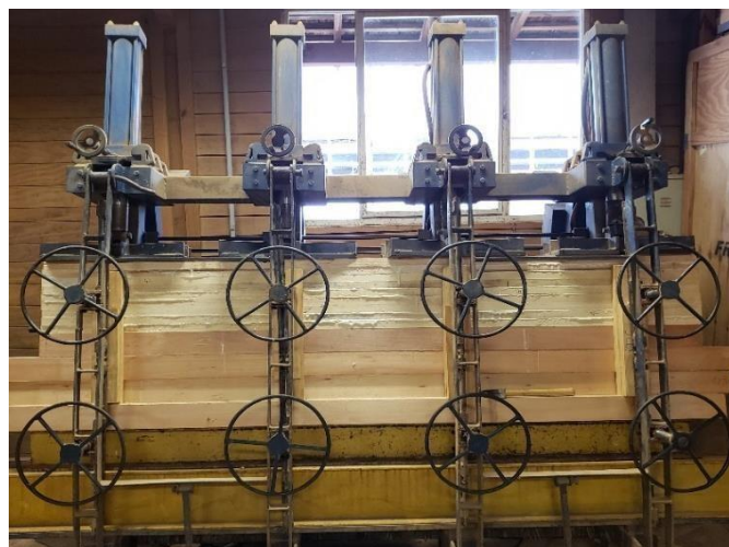
Figura 22: Prensa utilizada nas vigas de Madeira Lamelada colada.
