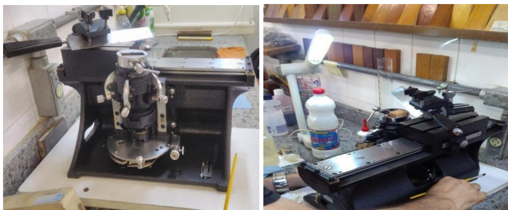
Figura 4: Micrótomo utilizado para cortar os corpos de provas com espessura de 18 micrômetro ( \mu\text{m} ).
