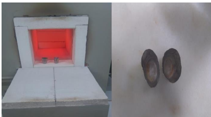
Figura 11: Cadinhos na mufla em uma temperatura de 850°C, e cadinhos com resíduos de sílicas no recipiente
