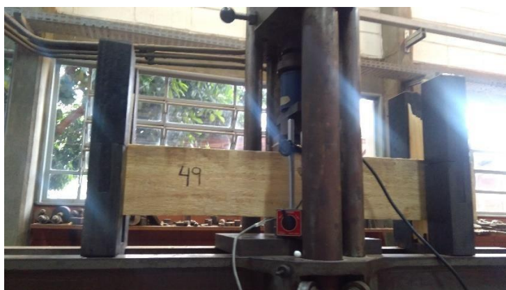
Figura 17: Ensaio para a determinação da resistência à compressão e rigidez normal às fibras.
