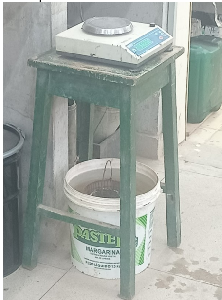
Figura 27 - Pesagem da Massa submersa do Corpo de Prova.
