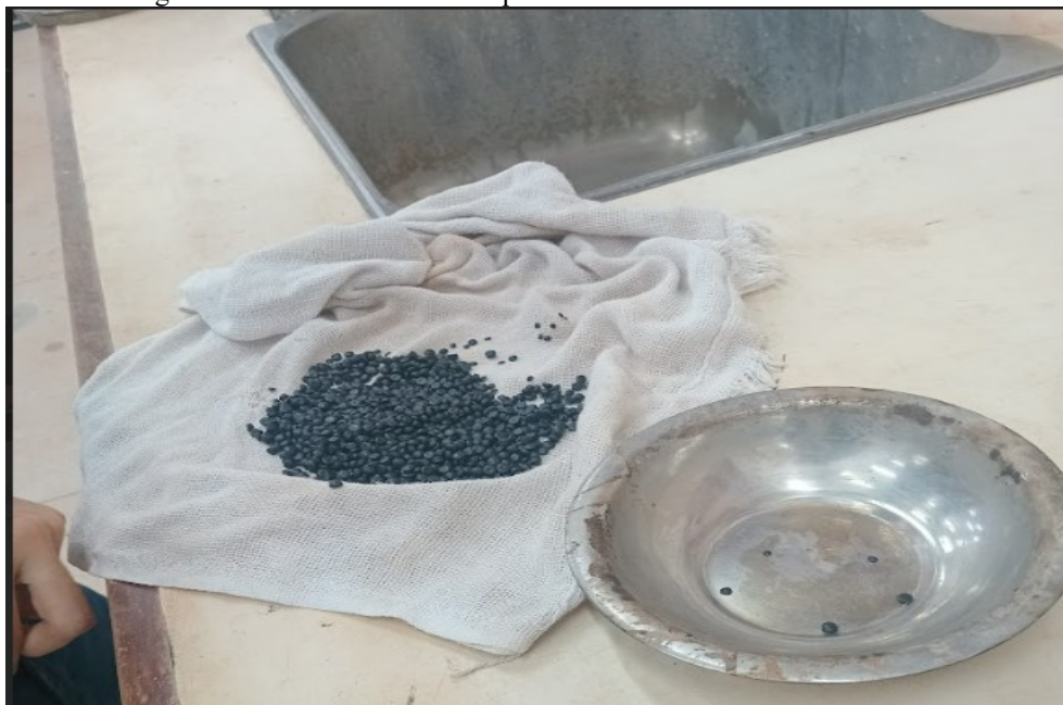
Figura 2 - Partículas do resíduo plástico reciclado de média densidade.
