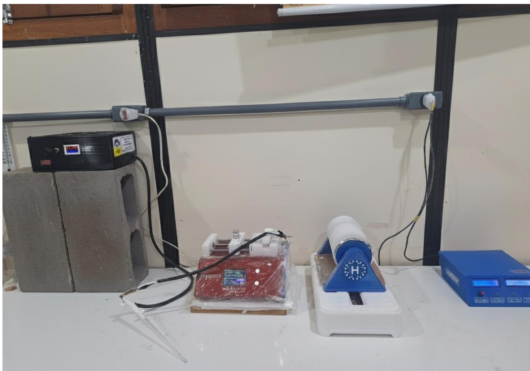
Figura 13: Co-eletrofiação do PLC e PLA
