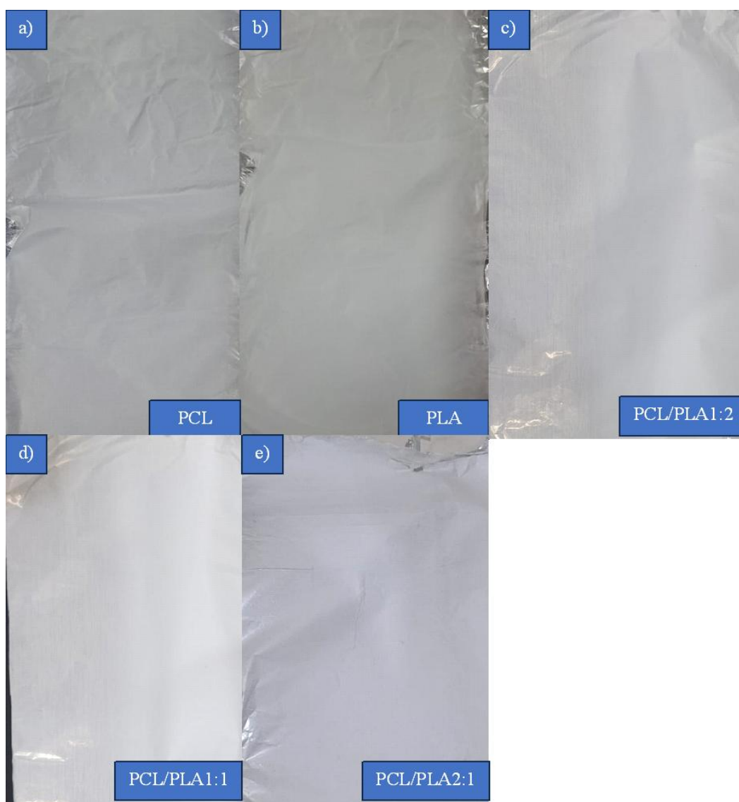
Figura 16: Imagem das membranas eletrofiadas: a) PLA; b) PCL c) membrana co-eletrofiada de PCL/PLA 1:2; d) membrana co-eletrofiada de PCL/PLA 1:1; e) membrana co-eletrofiada de PCL/PLA 2:1
