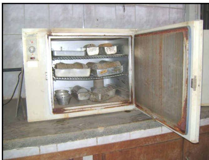
Figura 60 - Corpo de prova em estufa após o ensaio de módulo de resiliência até a sua constância de massa.
