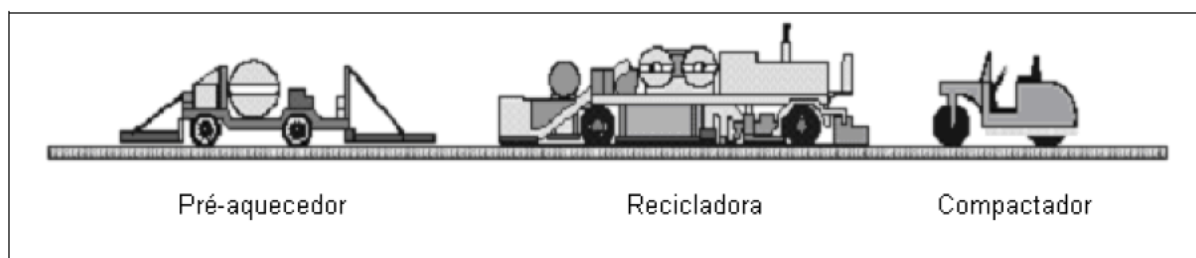
Figura 8 - Esquema da operação da reciclagem a quente in situ com fresagem a quente. Fonte (PINTO 2002).
