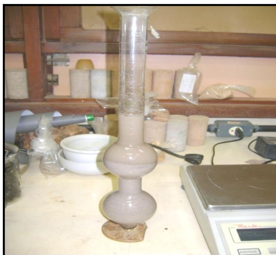
Figura 65 - Ensaio para a determinação da massa específica da areia utilizando o frasco de Chapman.
