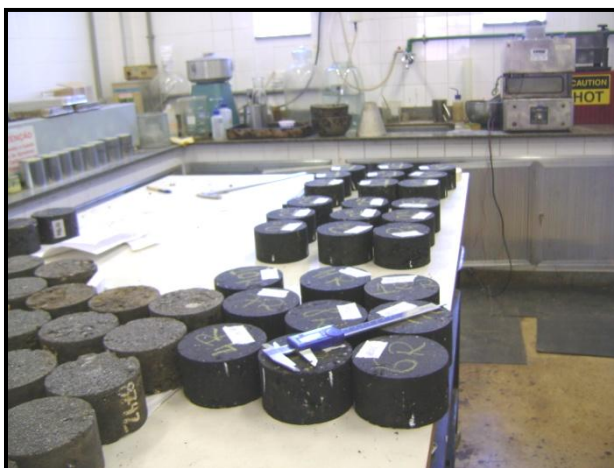
Figura 78 - Corpos de prova catalogados, prontos para os ensaios de MR e RT.
