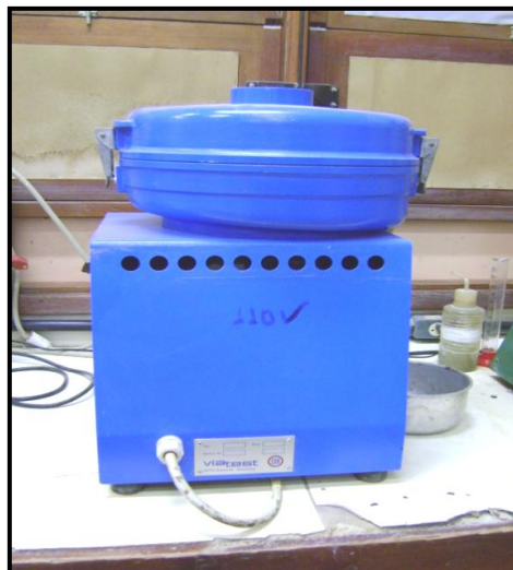
Figura 64 - Extrator por centrifugação usado para extrair o CAP do RFA.
