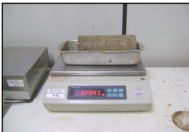
Figura 59 - Pesagem do corpo de prova após o ensaio de módulo de resiliência.
