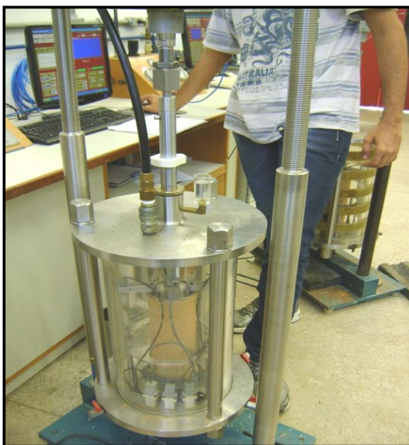
Figura 61 - Equipamento triaxial de carga repetida do laboratório de Geotecnia/Pavimentos da COPPE/UFRJ, usado nesta pesquisa.
