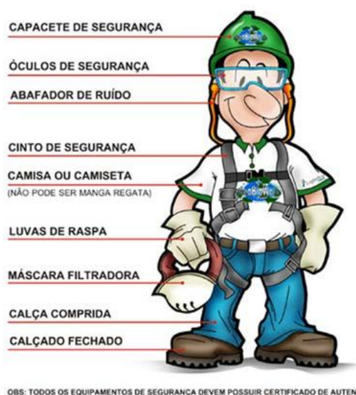
Figura 3. Desenho esquemático especificando os tipos de equipamentos de proteção individual Fonte: WS Soluções corporativas. Por que usar EPI? (2022).
