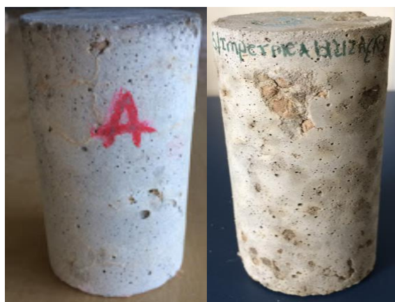
Figura 24-comparação macroscópica entre os corpos de provas I- Impermeabilizados com a resina em extraído em breu. II- corpo de prova sem tratamento de impermeabilização.
