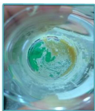
Figura 14- Resíduo de resina de breu extraído em acetato, massa residual hidrofóbica.
