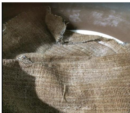
Figura 31-Impermeabilização do tecido de juta e malva.
