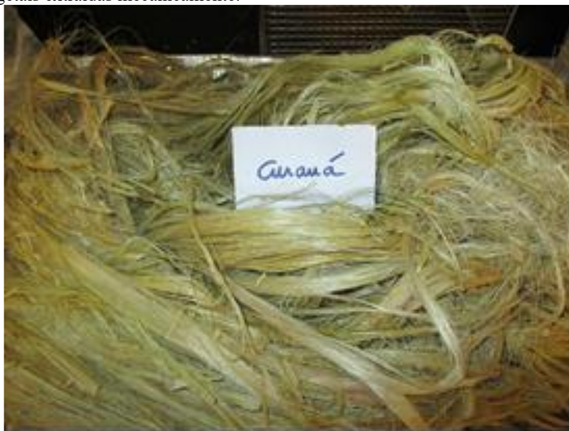
Figura 05. Fibras vegetais extraídas mecanicamente.
