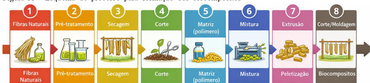
Figura 06 – Esquema de processo para formação dos biocompósitos
