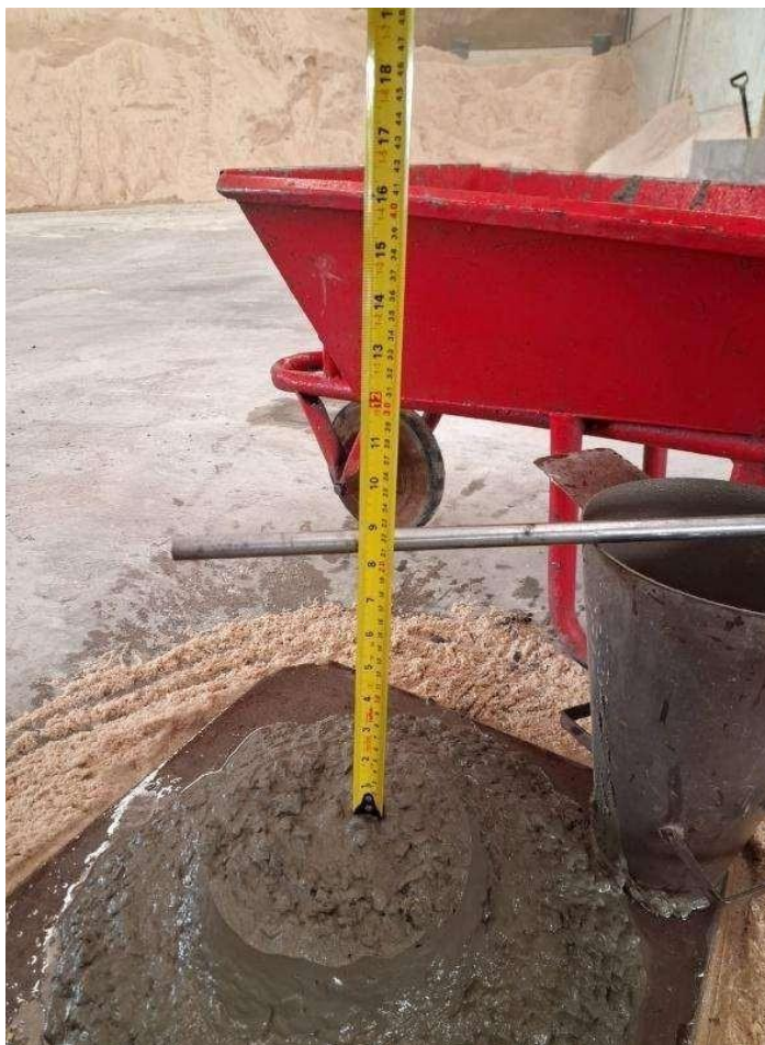
Figura 2: Medição do abatimento
