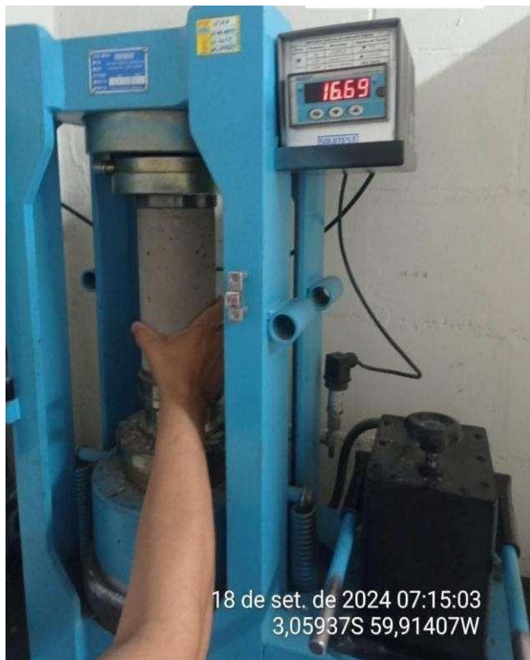
Figura 5: Ensaio de compressão dos corpos de prova
