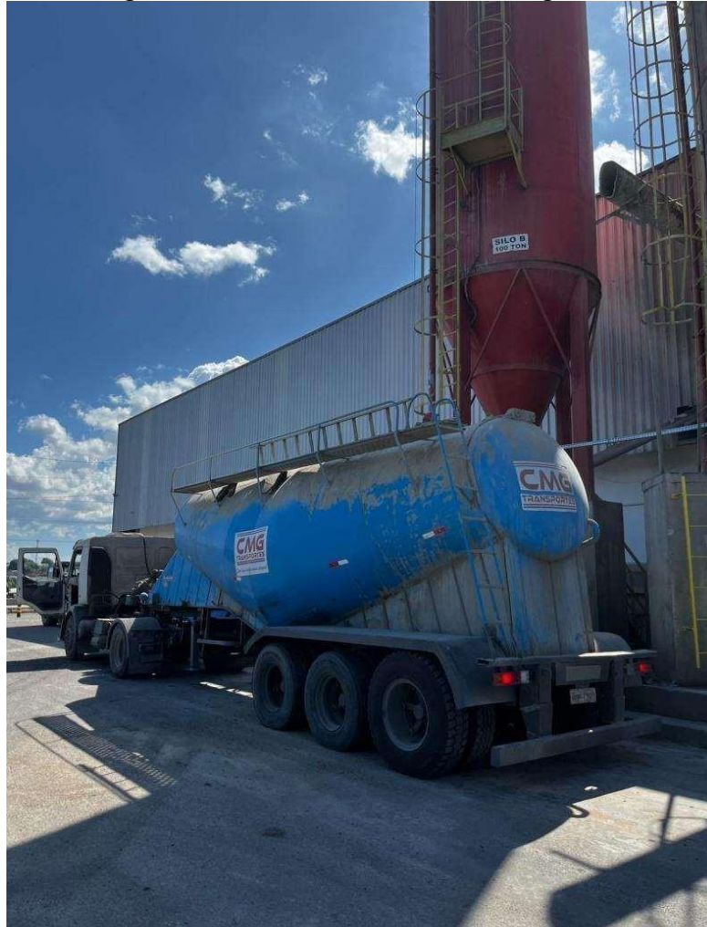
Figura 10: Recebimento do cimento a granel
