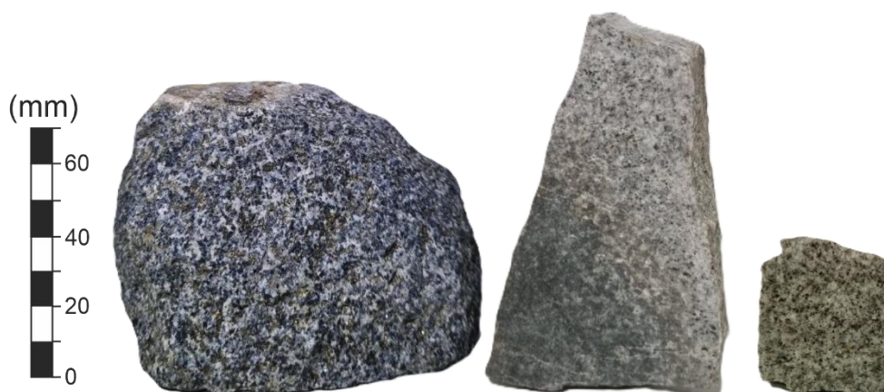
Figura 12: Representação da variação composicional dos dioritos, do diorito (amostra à esquerda) ao quartzo-diorito (amostra à direita), e contato transicional entre os litotipos (amostra central).
