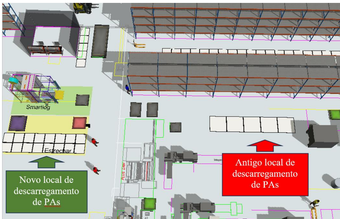
Figura 43 - Evidência do Antigo e Novo posicionamento de PAs não embalados na fábrica
