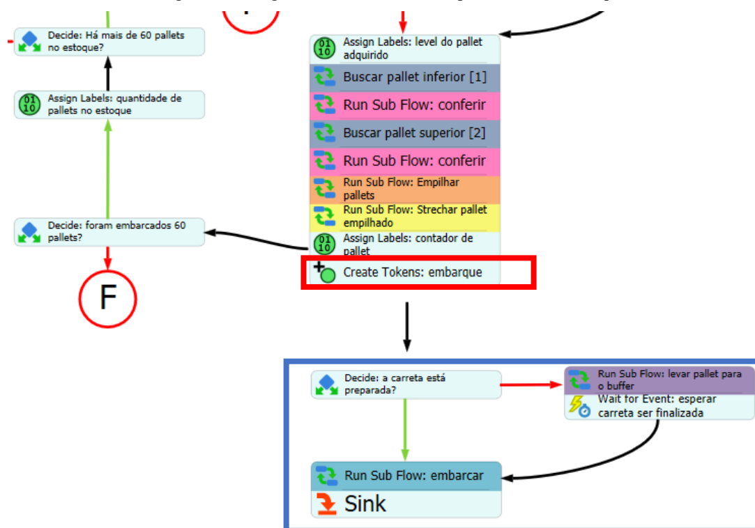
Figura 51 – Lógica no Process Flow do processo de Embarque
