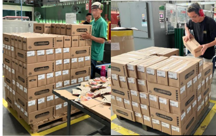
Figura 12 - Ilustração de empilhamento das caixas em paletes no setor de produção
