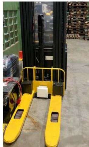
Figura 55 – Leitor RFID posicionado na parte frontal do transpaleteira.
