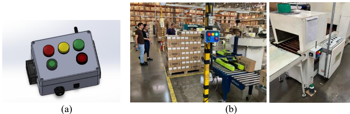
Figura 57 - Gabinete do dispositivo de solicitação de coleta (a) protótipo (b) instalado no posto
