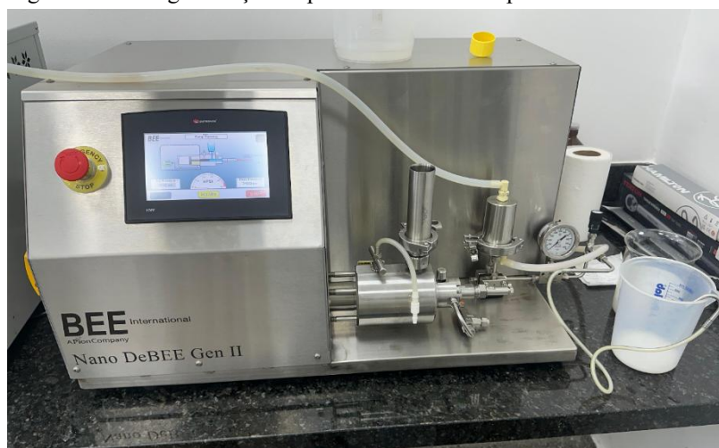
Figura 8 - Homogeneização da pré-emulsão em alta pressão.
