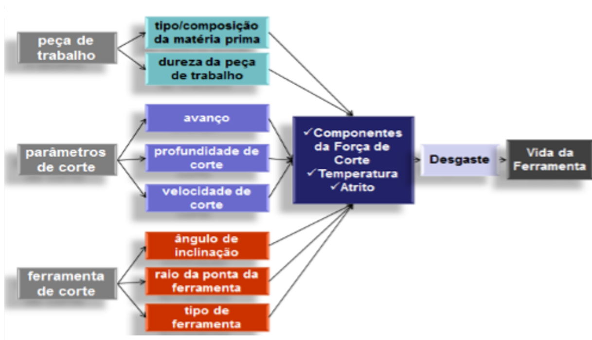
Figura 3.1: Efeitos dos diferentes parâmetros no desgaste de ferramenta.
