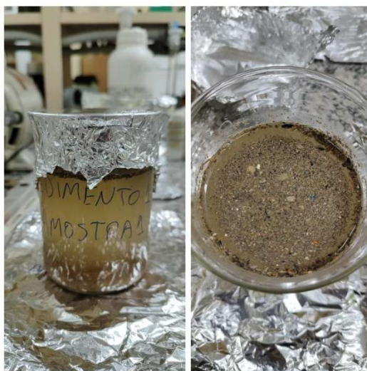
Figura 11 - Amostra com solução de \text{ZnCl}_2 para separação por densidade.
