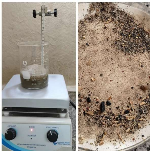
Figura 12 - Degradação da matéria orgânica e o material filtrado e seco.
