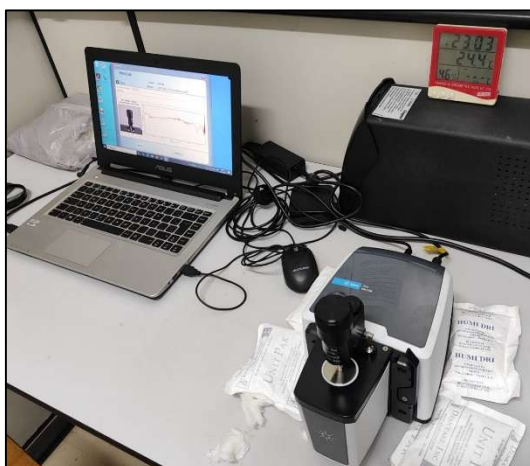
Figura 14 - Espectrômetro FTIR-ATR no centro de apoio multidisciplinar – CAM – Biotecnologia UFAM.
