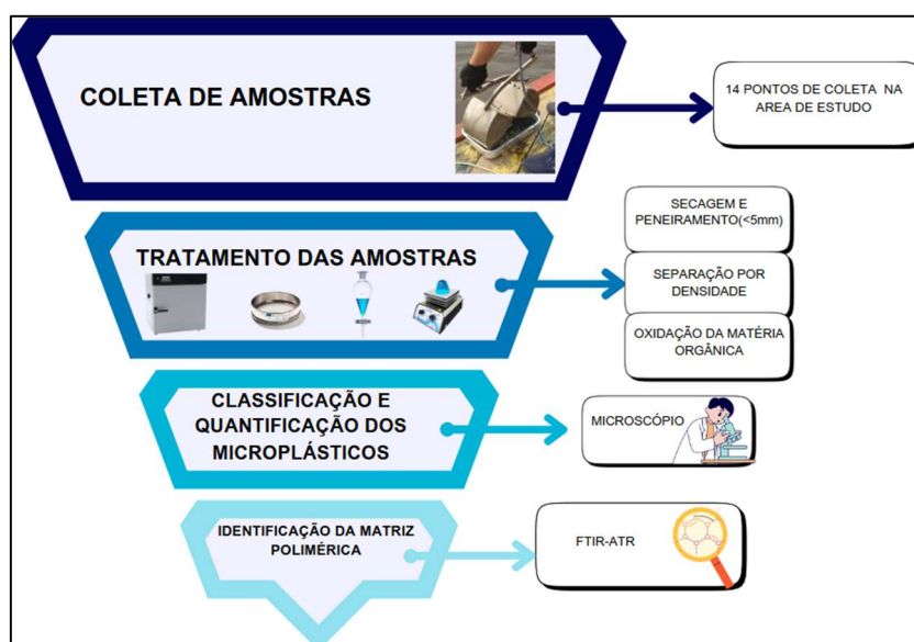
Figura 10 - Etapas do processamento das amostras coletadas.
