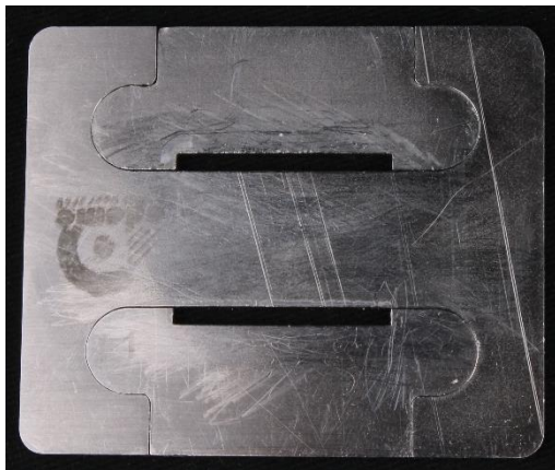
Figura 1. Matriz retangular bipartida em forma de barra com dimensões de 25 mm × 2 mm × 2 mm utilizada para confecção dos corpos de prova para os testes de resistência flexural e módulo flexural.
