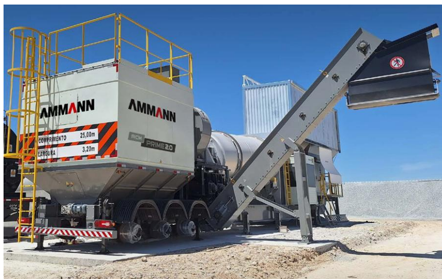
Figura 3.6 - Usina ACM Prime 2.0 da AMMANN.
