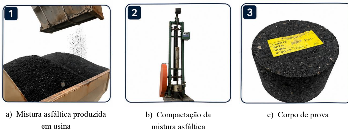
Figura 3.7 - Confeção dos corpos de prova de laboratório
