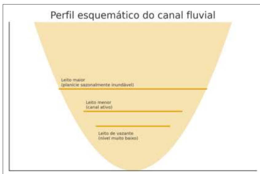
Figura 14 - Perfil esquemático do canal fluvial: leito menor, leito maior e leito de vazante.
