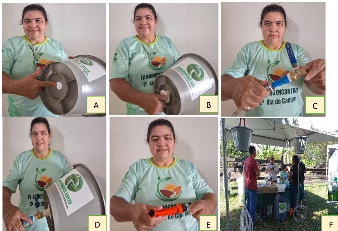
Figura 9- montagem do Kit EMBRAPA mostrando onde e como encaixa e suas peças; 9A - Abertura do balde; 9B- Adaptador sendo inserido ao balde; 9C- Registro esfera sendo acoplado; 9D - unindo a mangueira ao adaptador; 9E- prendendo o esguicho na mangueira; 9F- Demonstração do balde em ponto alto para realizar a ordenha.
