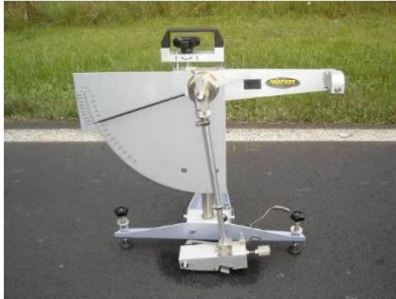
Figura 12 – Pêndulo Britânico (fonte: CONCEPA – LAPAVE, 2010).
