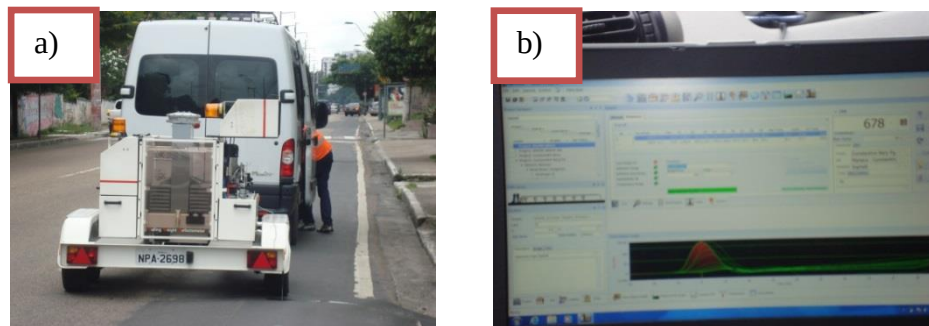
Figura 43 – Procedimento do ensaio a) início com parada no ponto de impacto b) controle do ensaio por computador.
