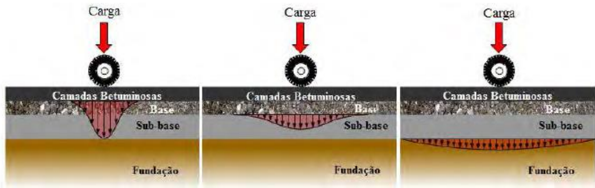
Figura 5 – Degradação nas várias camadas que constituem o pavimento (PTC 2005).
