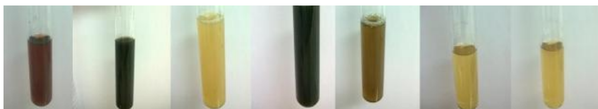
Figura 1 - Diferença de coloração das nanopartículas de prata
