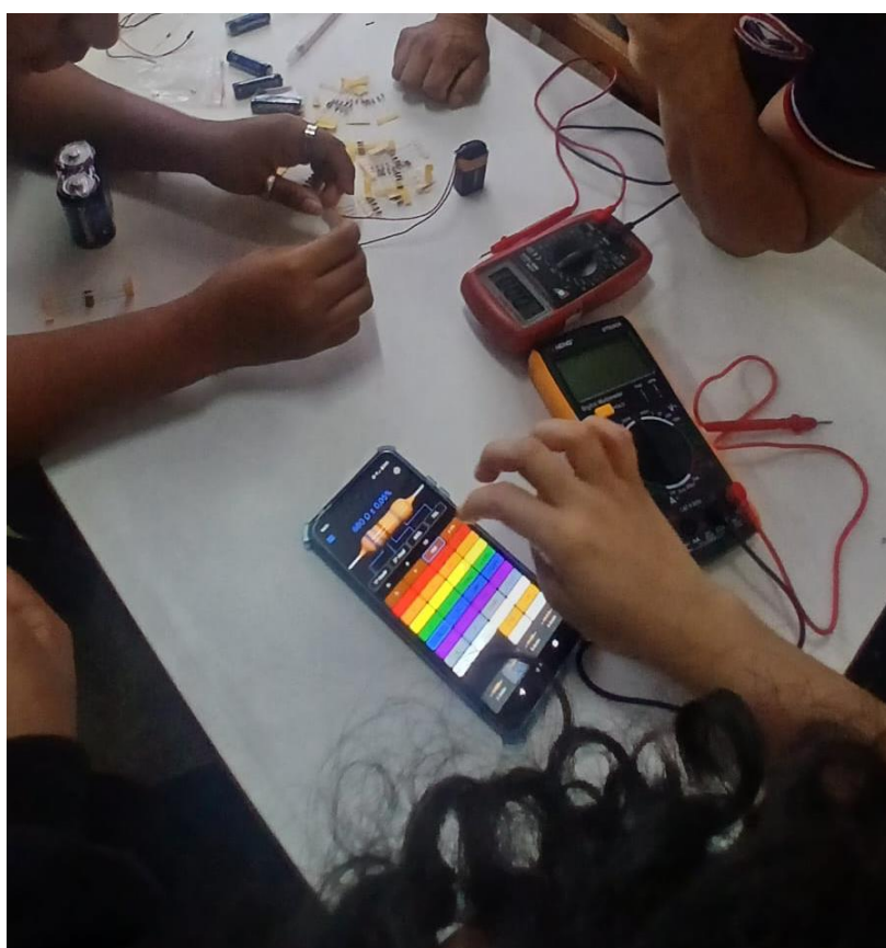
Figura 4.3: identificação de resistores utilizado o aplicativo Calculador de Resistor
