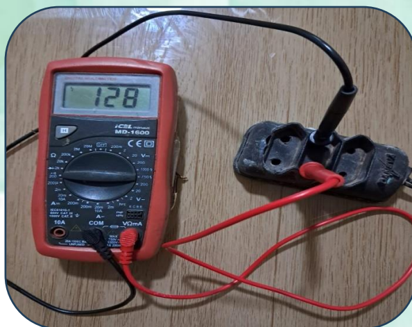
Figura 8: Medindo a tensão elétrica de uma tomada
