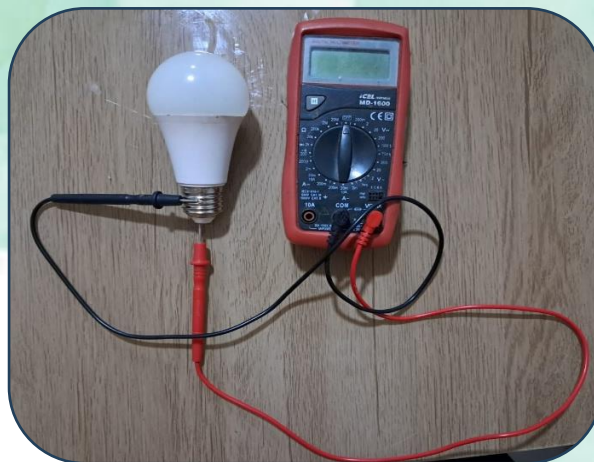
Figura 10: Medindo a continuidade de uma lâmpada
