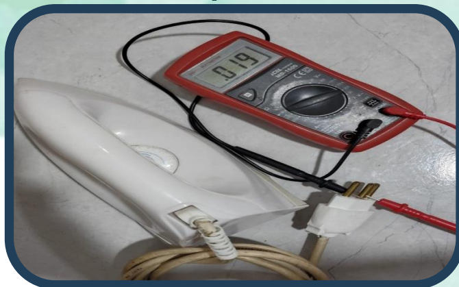
Figura 9: Medindo a resistência elétrica de um feero de passar
