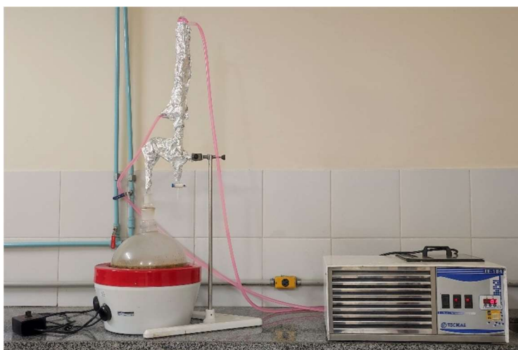
Figura 15. Método de hidrodestilação. Fonte: Ana Karoline Alves de Souza.
