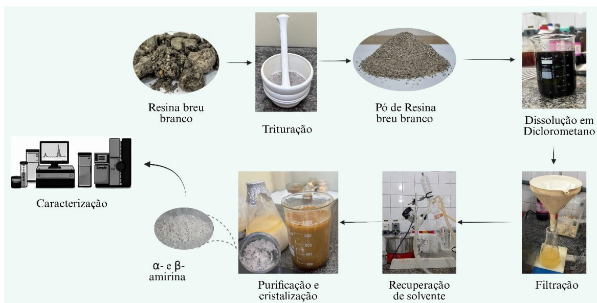
Figura 12. Procedimento experimental da extração da \alpha - e \beta -amirina
