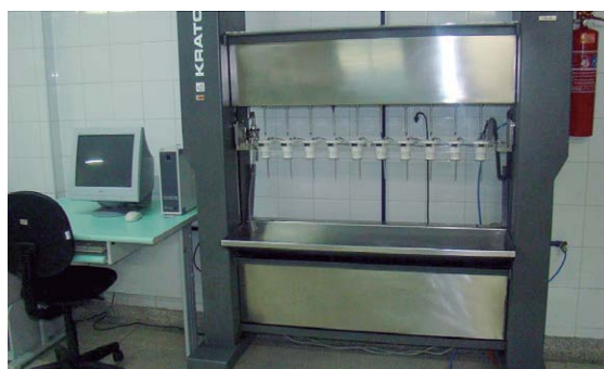
Figura 43: Máquina de verificação de orifícios.
