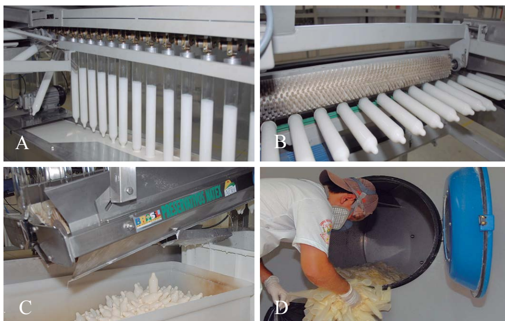
Figura 9: Fabricação de preservativos: A- Banho de imersão; B- Formação de bainha; C- preservativo desmoldados; D- produto semi-acabado
