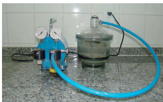
Figura 46: Teste de Integridade de embalagem primária
