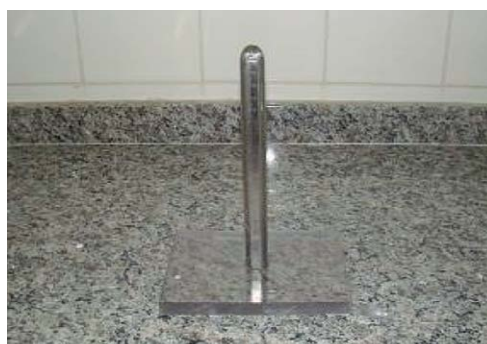
Figura 44: Mandril para realização dos testes de comprimento.
