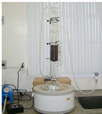
Figura 40: Extração com solvente com o sistema de extração de Soxhlet
