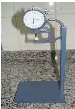
Figura 45: Relógio comparador para realização do teste de espessura
