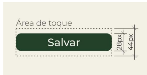
Figura 104. Especificações técnicas do botão de ação, destacando a área de toque ( touch target ) em relação à altura visual do componente
