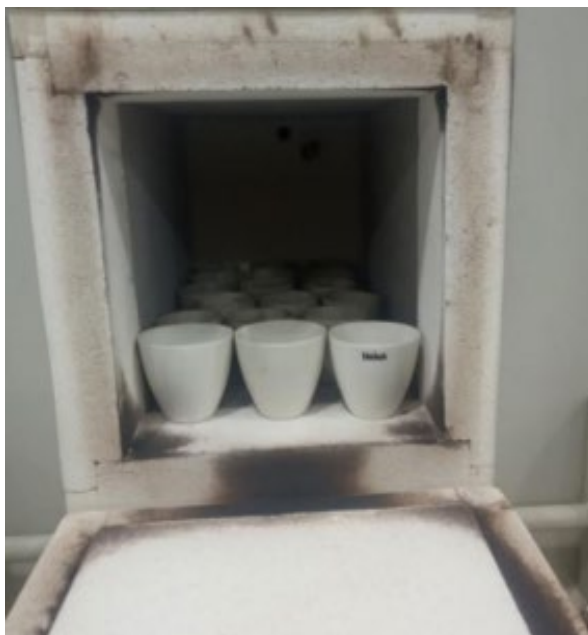
Figura 16. Cadinhos com amostra colocados na mufla a 550°C durante 4 horas
