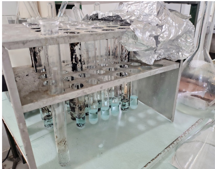
Figura 28. Digestão completa/líquido claro
