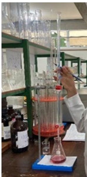
Figura 32. Final da reação de titulação - Mudança na coloração azul para rosa clara
