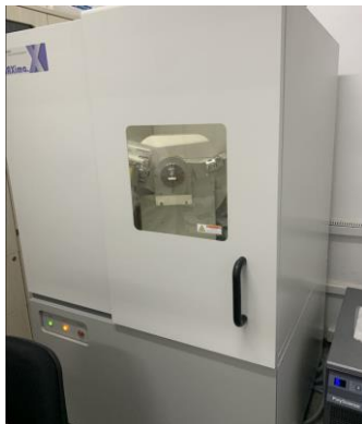
Figura 9. Difratômetro de Raios X Shimadzu, modelo XRD-6000 com anodo de cobre ( \text{CuK}\alpha : \lambda = 0,154184 \text{ nm} ), utilizado para análise das amostras.
