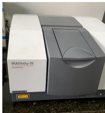
Figura 54. Espectrômetro de infravermelho com transformada de Fourier Shimadzu – Affinity-1S.
