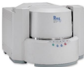
Figura 8. Espectrômetro de fluorescência de raios X por dispersão de energia (Shimadzu, EDX 720) utilizado para análise do caulim.
