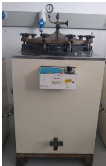
Figura 53. Autoclave vertical utilizada para o tratamento hidrotérmico das biomassas .
