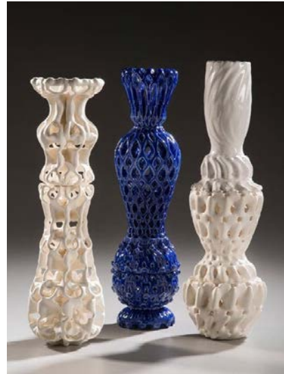
Figura 5. Peças em cerâmica com certo grau de complexidade, desenvolvidas por meio de impressão tridimensional.
