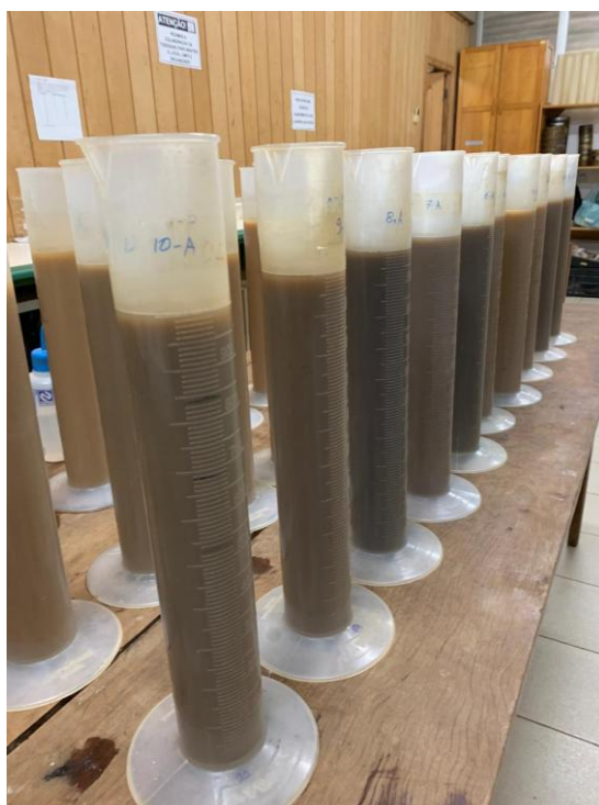
Figura 10. Processo de decantação onde ocorre a separação de misturas heterogêneas
