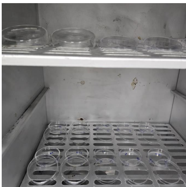
Figura 14 - Soluções filmogênicas vertidas, sob secagem em estufa com circulação de ar
