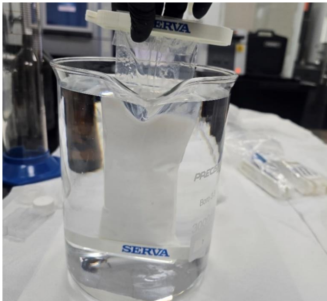
Figura 11 - Sistema de diálise: Tubo contendo extrato, imerso em solução de AcOH 0,1 mol.L -1
