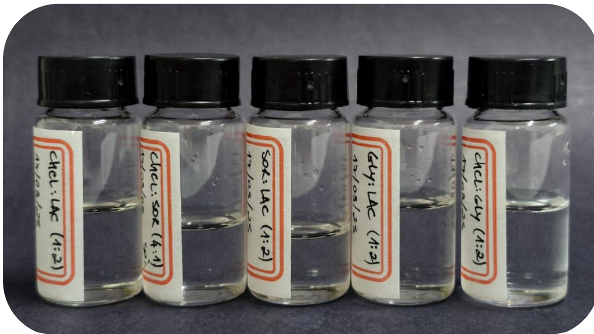
Figura 7. Sistemas de solventes eutéticos sintetizados: (1) Cloreto de colina : Ácido láctico (1:2); (2) Cloreto de colina : Sorbitol (4:1); (3) Sorbitol : Ácido láctico (1:2); (4) Glicerol : Ácido láctico (1:2); (5) Cloreto de colina : Glicerol (1:2).
