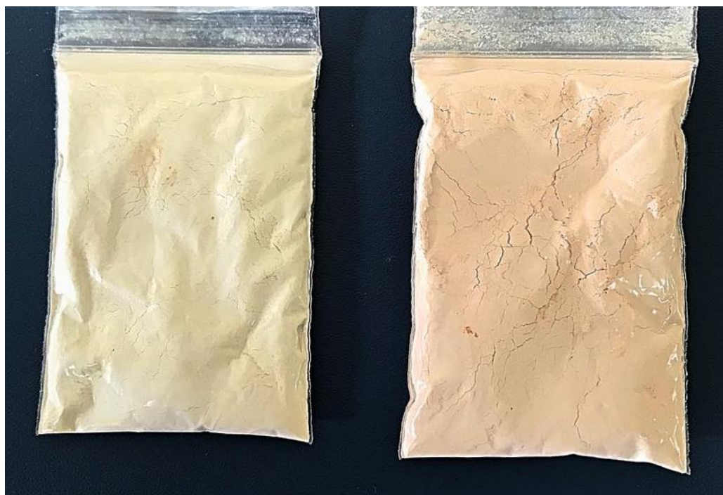
Figura 7 – Efeito da calcinação na cor das argilas.
