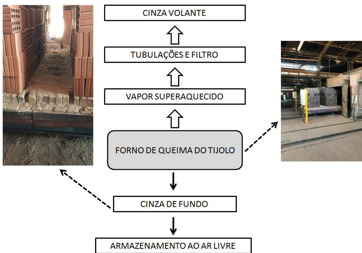
Figura 3: Fluxograma do processo para geração de Cinzas.
