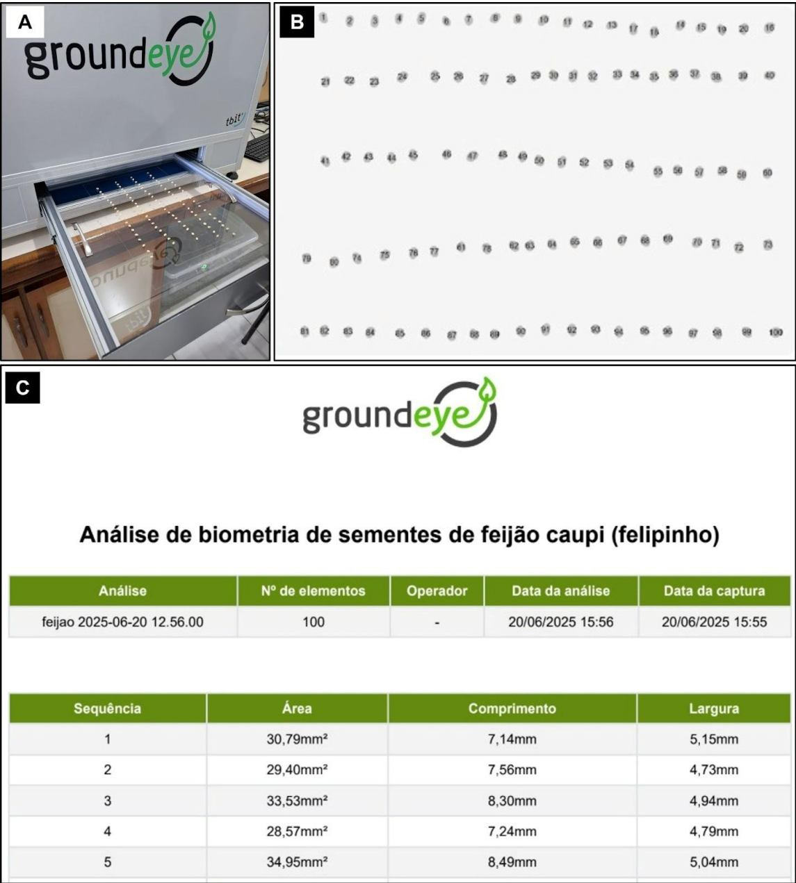
Figura 2. Metodologia da análise morfométrica das sementes de três variedades de feijão-caupi ( Vigna unguiculata (L.) Walp.). A – Disposição das sementes no Scanner digital GroundEye®. B – Marcação e contagem das sementes pelo Software do equipamento. C – Relatório dos dados emitido pelo software do equipamento. Manaus, 2025.
