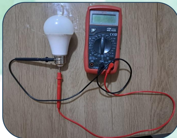
Figura 10: Medindo a continuidade de uma lâmpada
