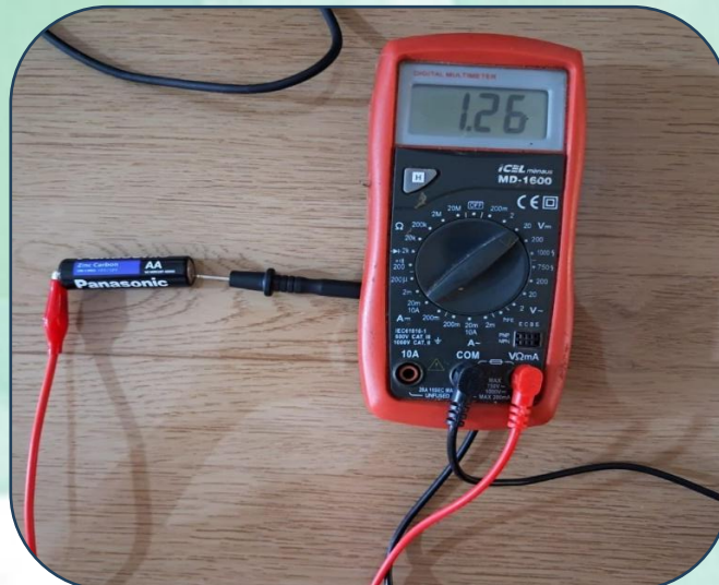
Figura 11: Medindo a tensão de uma pilha
