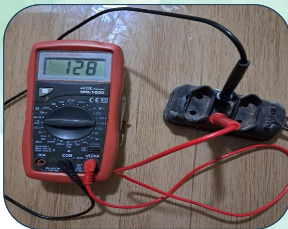
Figura 8: Medindo a tensão elétrica de uma tomada
