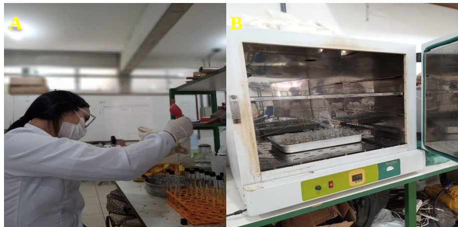
Figura 47 – Retirada de 5ml do filtrado (A) e backers na estufa à 100°C (B)
