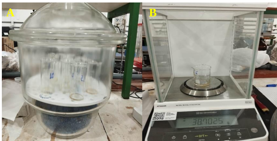
Figura 48 – Backer no dessecador (A) e pesagem (B)
