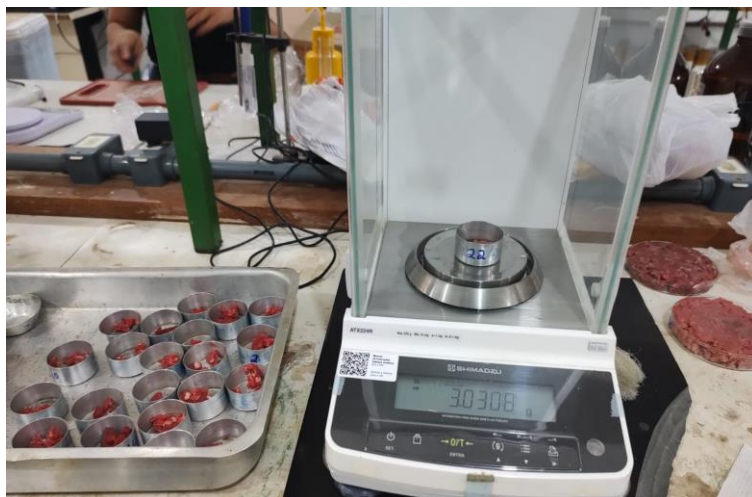
Figura 34 – Pesagem de 3,00g de cada amostra para a secagem em estufa à 105°C
