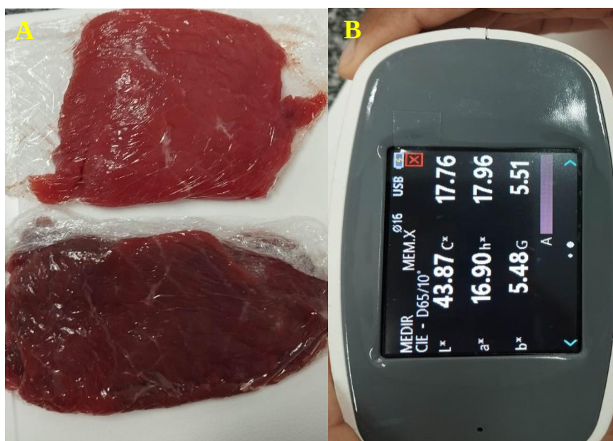
Figura 31 – Carne sobre a placa branca (A) e Colorímetro Delta Color (B)
