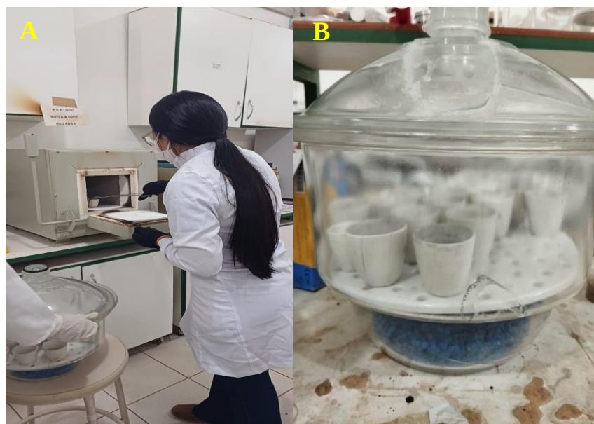
Figura 36 – Retirada dos cadinhos da mufla (A) Cadinhos com as amostras no Dessecador (B)
