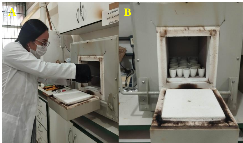
Figura 38 – Cadinhos com amostras adicionados na mufla à 550°C
