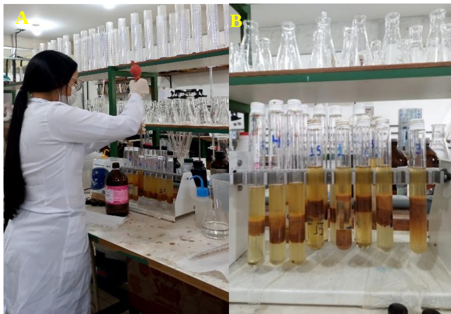
Figura 43 – Adição de clorofórmio (A) e separação das frações (B)
