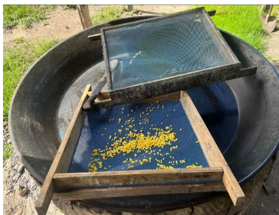
Figura 23 – Peneiras utilizadas para controle de qualidade dos grãos da farinha de mandioca
