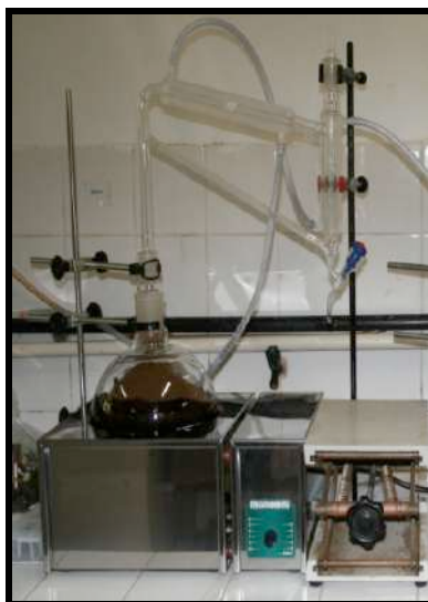
Figura 10 - Sistema de Clevenger modificado para extração de óleo essencial Foto: Corrêa, R. F.
