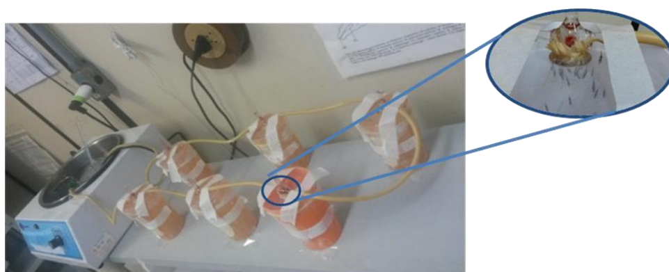
Figura 13. Sistema de infecção experimental, composto por alimentadores de vidro conectados por mangueiras a um banho-maria. Em destaque, alimentador de vidro e mosquitos se alimentando.
