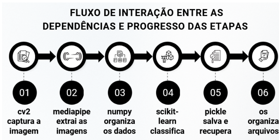
Figura 5.2: Fluxo de processamento e integração entre bibliotecas na aplicação de reconhecimento gestual.
