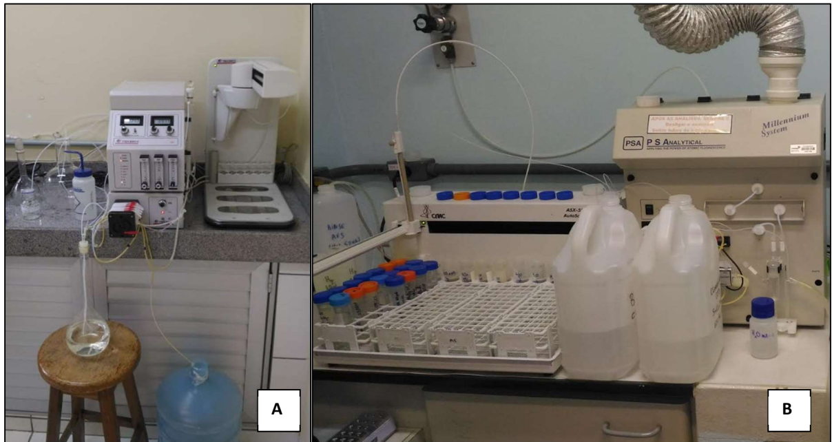
Figura 7. Equipamentos CV-AFS: A) modelo Tekran® 2600; B) modelo 10.045 Millennium Merlin Cold Vapor AAS System – P. S. Analytical.
