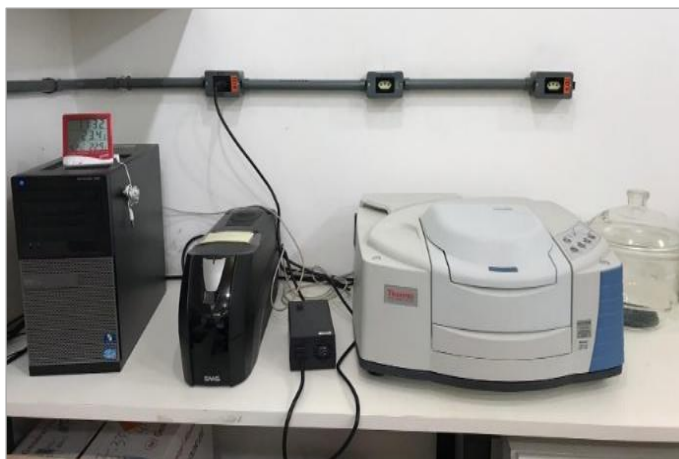
Figura 15. Espectrofotômetro FTIR Thermo Scientific, modelo Nicolet iS10, modo de transmissão com pastilha de KBr.
