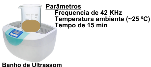
Figura 10. Etapas I, II e III: preparo e mistura das soluções precursoras, ajuste do pH e processo de sonicação.
