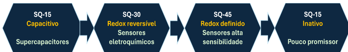
Figura 33. Evolução do comportamento eletroquímico com o tempo de síntese das amostras SQ-15, SQ-30, SQ-45 e SQ-60.
