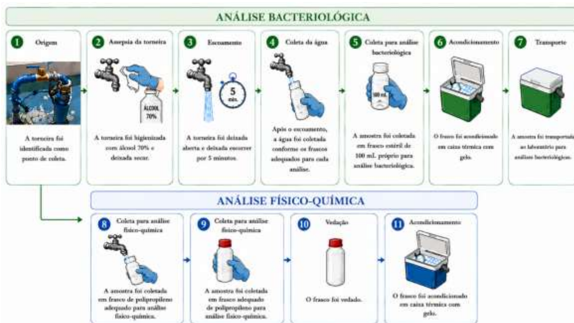
Figura 9 - Fluxograma do procedimento de coleta, acondicionamento e transporte de amostras de água subterrânea destinadas às análises bacteriológicas e físico-químicas.
