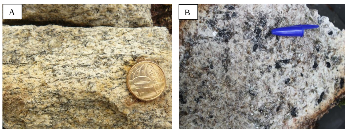
Figura 3.10: (A) Muscovita leucogranito foliado. Amostra MA-05. (B) Aspecto do granito com textura grossa a pegmatóide, em destaque os cristais de turmalina preta (afrisita). Amostra MA-06.
