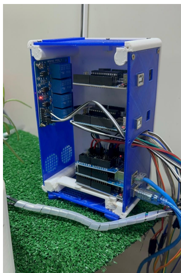
Figura 13 – Estrutura do ERPLabSERVER: Componentes Arduino e Shields
