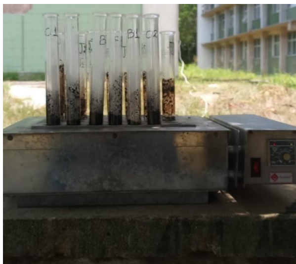
Figura 12: Digestão das amostras no bloco digestor.
