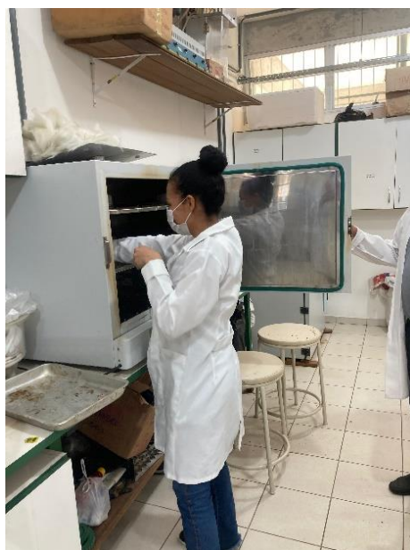
Figura 43: Formas sendo colocadas na estufa a 90°C
