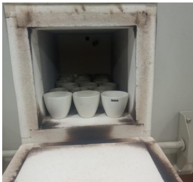
Figura 8: Cadinho no forno mufla a 550°C
