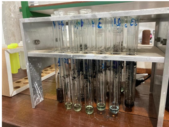
Figura 15: Adição de água destilada nos tubos.
