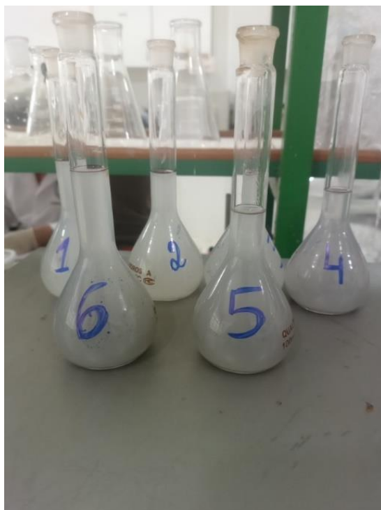
Figura 32: Cinzas dissolvidas em HNO_3 a 10%
