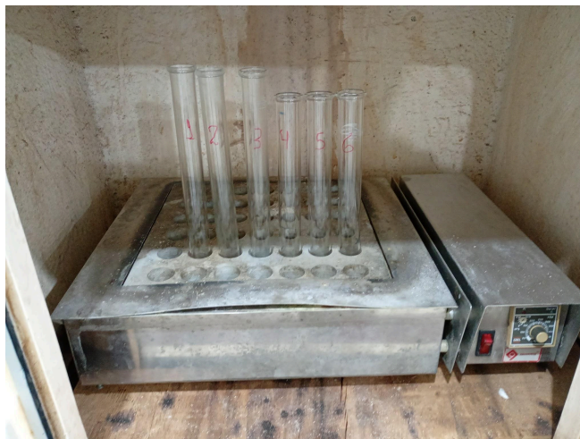
Figura 23: Bloco digestão de material orgânico.
