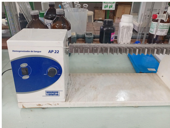
Figura 14: Agitador de sangue utilizado na extração de lipídeos.
