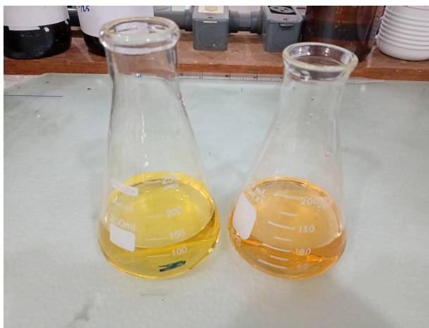
Figura 22: Erlenmeyer a esquerda sem a titulação de HCl e Erlenmeyer a direita após a titulação de HCl.
