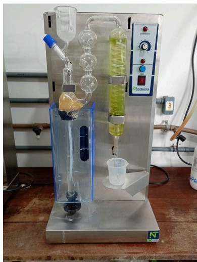
Figura 24: Destilador de Nitrogênio utilizado nas análises de proteínas.
