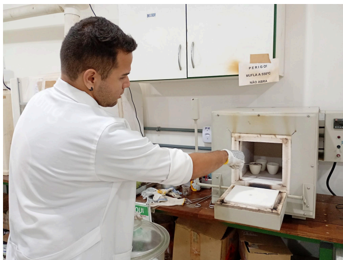
Figura 11: Cadinhos numerados e colocados na mufla para a esterilização e perda da umidade.
