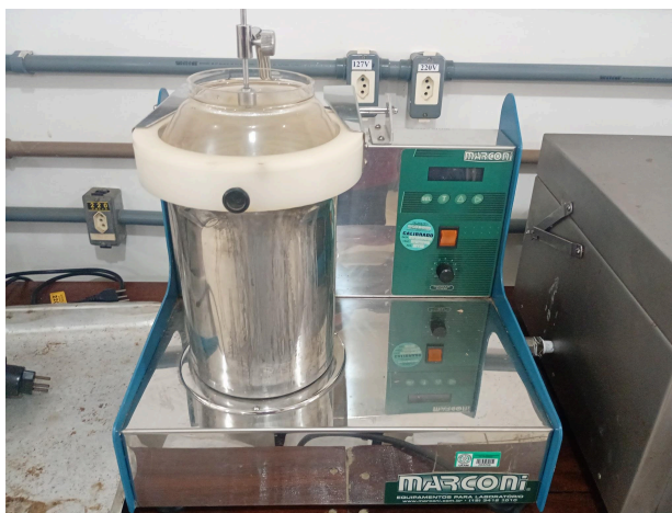
Figura 28: Determinador de fibra Bruta.
