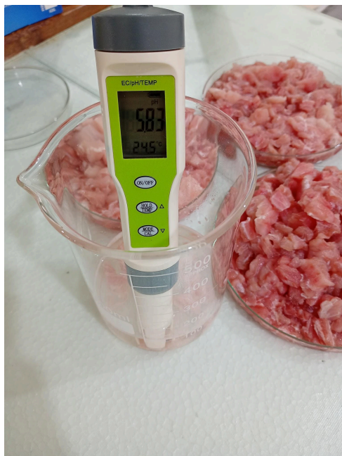
Figura 35: Medição do pH da carne de pescado.
