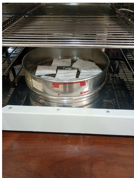
Figura 32: Saquinhos retirados da estufa após passar uma noite secando os resíduos de acetona e umidade.
