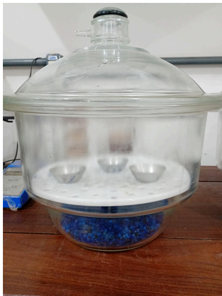
Figura 8: Dessecador utilizado para esfriar as cápsulas aquecidas sem que absorvam a umidade do ambiente.
