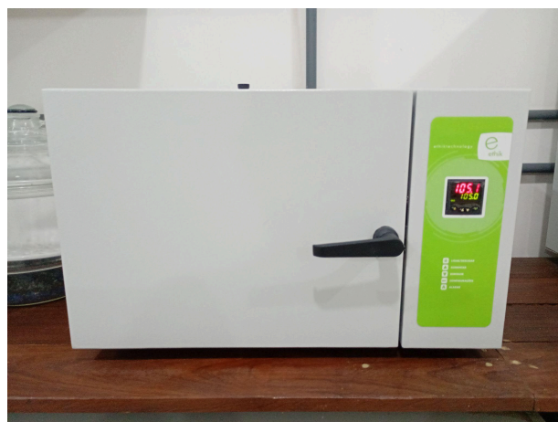
Figura 7: Estufa de ar e esterilização usada para a análise de umidade.
