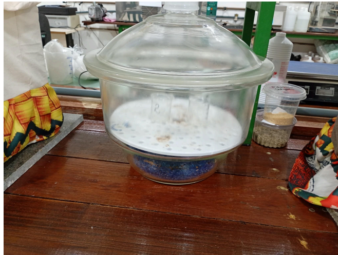
Figura 17: Beckers esfriando no dessecador após saírem da estufa.
