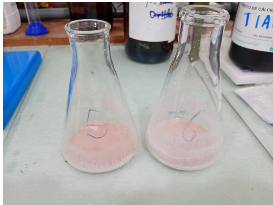
Figura 39: Ponto final da titulação após a virada de cor amarela para rosa.
