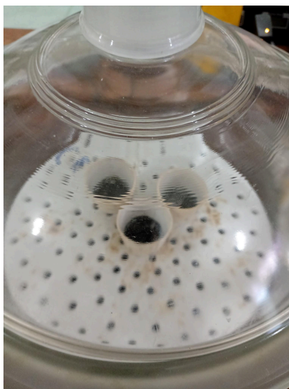
Figura 12: Cadinhos esfriando no dessecador contendo apenas os minerais totais da amostra analisada.
