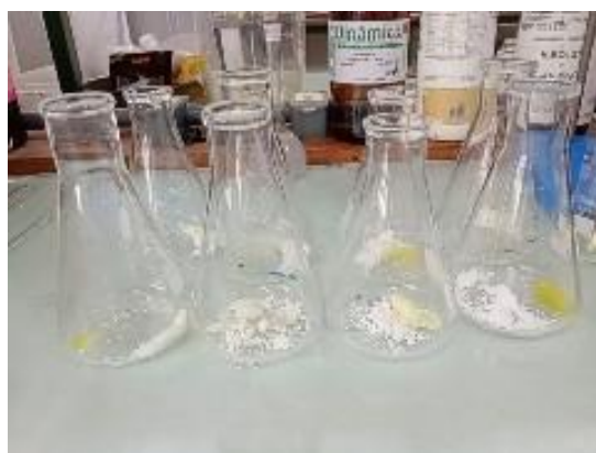
Figura 38: Adição de carbonato de cálcio e cromato de potássio no erlenmeyer de 250 mL
