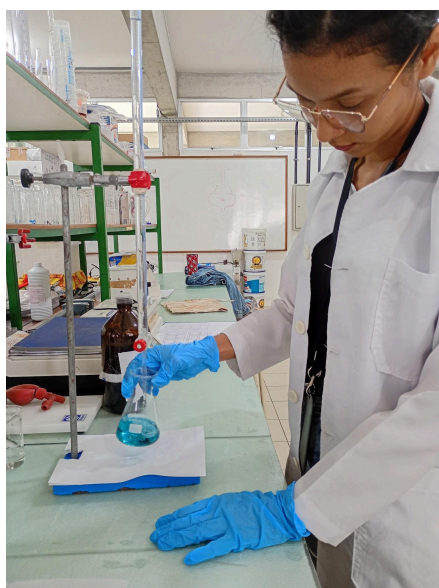
Figura 27: Titulação de ácido clorídrico no nitrogênio destilado.
