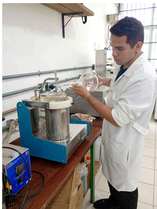
Figura 31: Adição da Solução de Ácido sulfúrico diluído em 1000 mL de água destilada.
