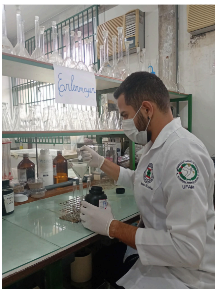
Figura 16: Adição de Sulfato de sódio anidro ao papel de filtro.
