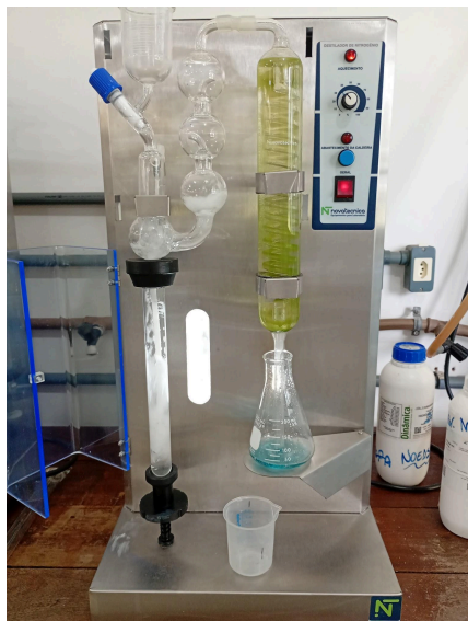
Figura 26: Reação do Ácido Bórico e nitrogênio destilado ficando com a cor azul.
