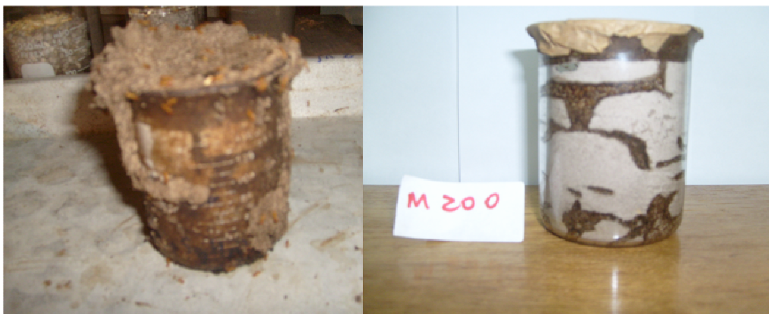
Figura 35- Barreiras de areias finas “quebradas” no período de 48 h.
