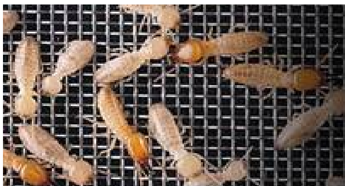
Figura 18- Tela de aço inoxidável (Termimesh®) aplicada em fundações nos EUA. Fonte: CSIRO (2007).
