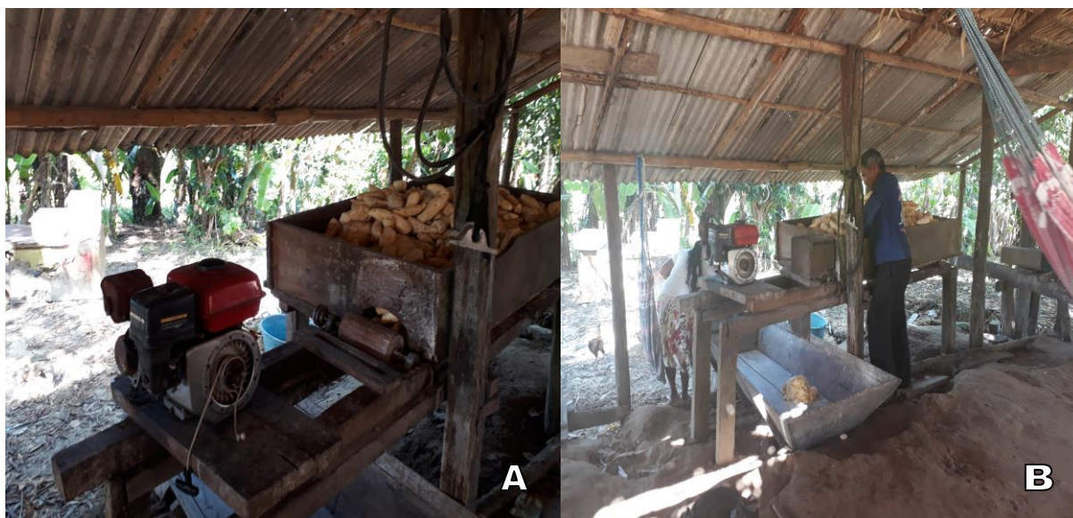
Figura nº 20 – Maquinário da prensa (A); camponês amazônico realizando a trituração (B). Fonte: Autora - trabalhos em campo, 2018. (Atualização, 2021/24).
