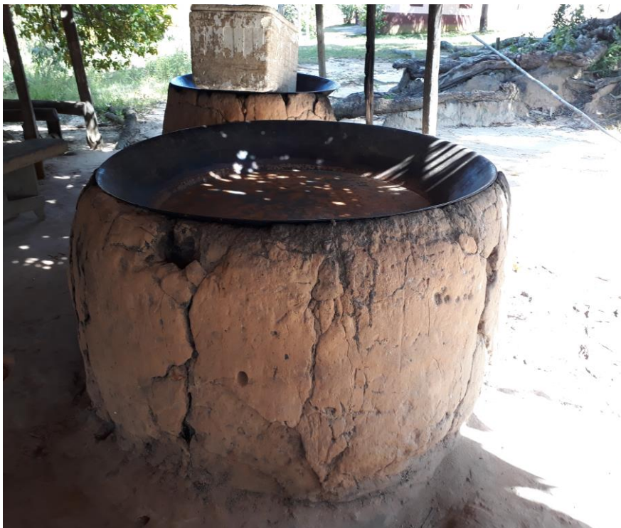
Figura nº 21 – Forno a lenha para torrar a mandioca e assim o preparo da farinha. Fonte: Autora - trabalhos em campo, 2018. (Atualização, 2021/24).
